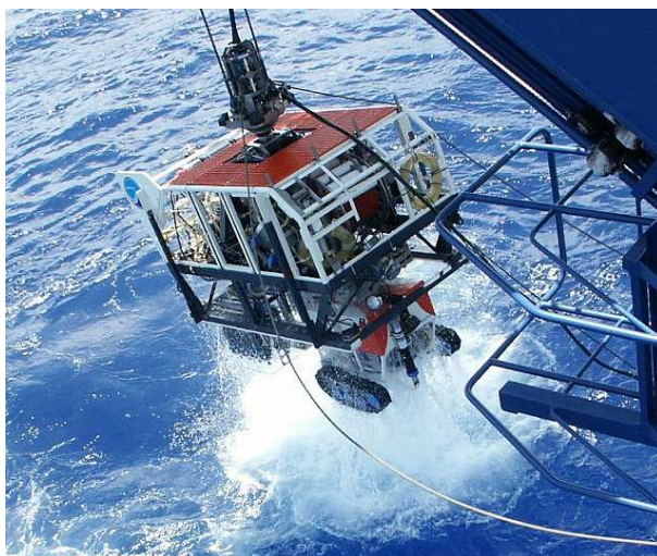
Fig. 16. The full depth ROV, ABISMO
