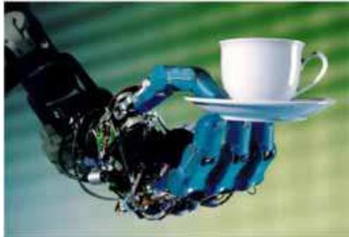
Fig. 1. DLR-II Hand (Butterfass et al. 2001).
