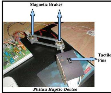
Fig. 19. Philau Haptic Device (Govindaraj et al, 2003a)
