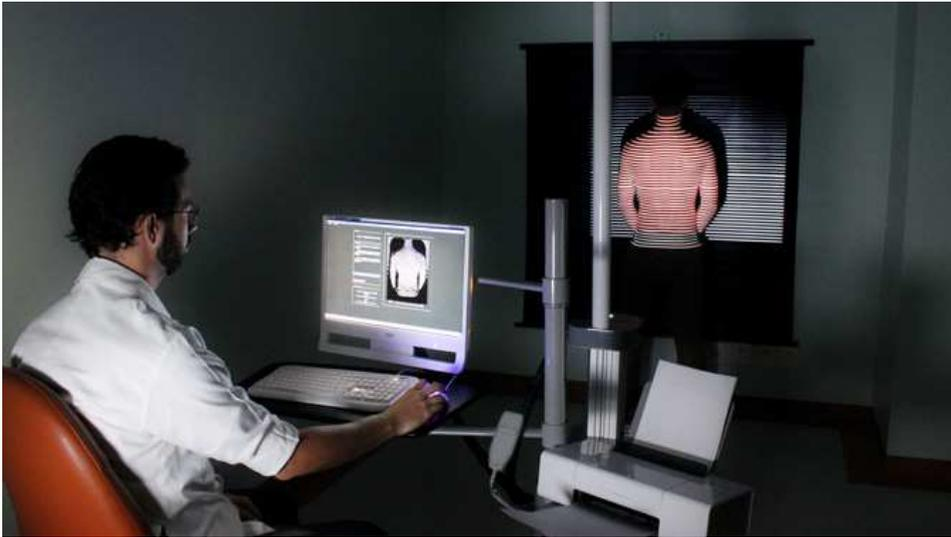
Fig. 2. Projection Moiré Technique. From: [www.miotec.com.br](http://www.miotec.com.br).
