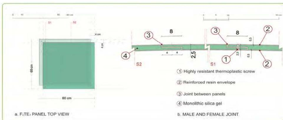
Fig. 11. F<sup>2</sup>TE<sup>3</sup> Envelope Profile Design
