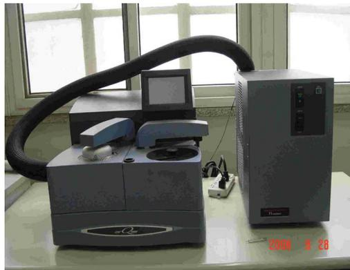
Fig. 20. Diagram of DSC
