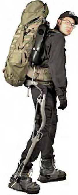
Fig. 6. Berkeley ExoHiker exoskeleton.
