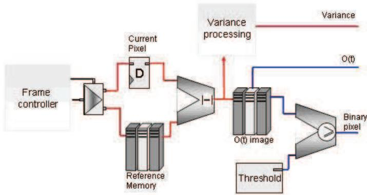
Fig. 10. Threshold module
