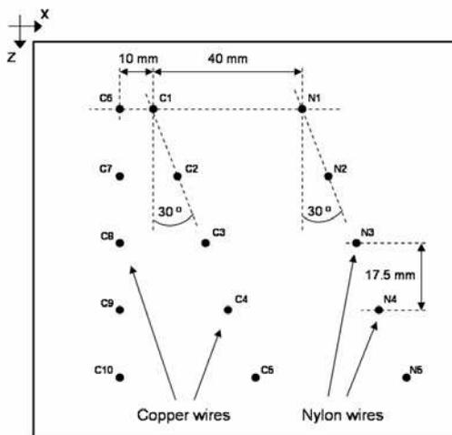
Fig. 22. Wire phantom.
