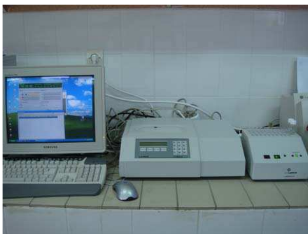
Fig. 4. Dr. Lange LUMIStox 300 Luminometer
