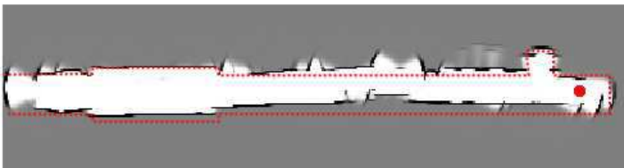
Fig. 16. Mapa construído com o modelo proposto e como correção dos erros sistemáticos de odometria.
