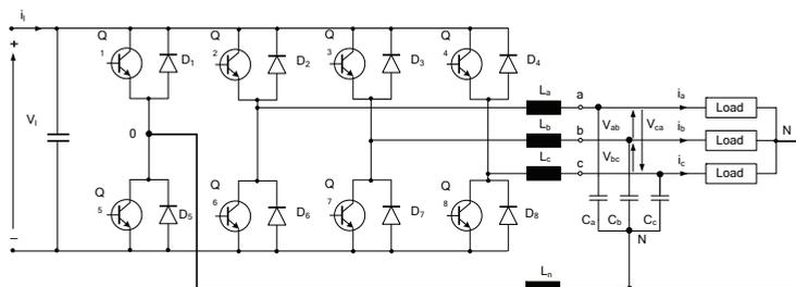
Fig. 21. Four-leg inverter.
