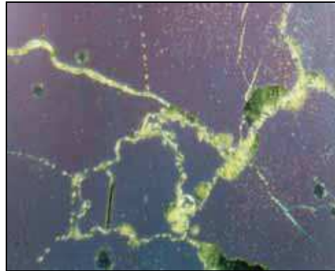
(d) transcrystalline fatigue crack growth through the intermetallic particle
