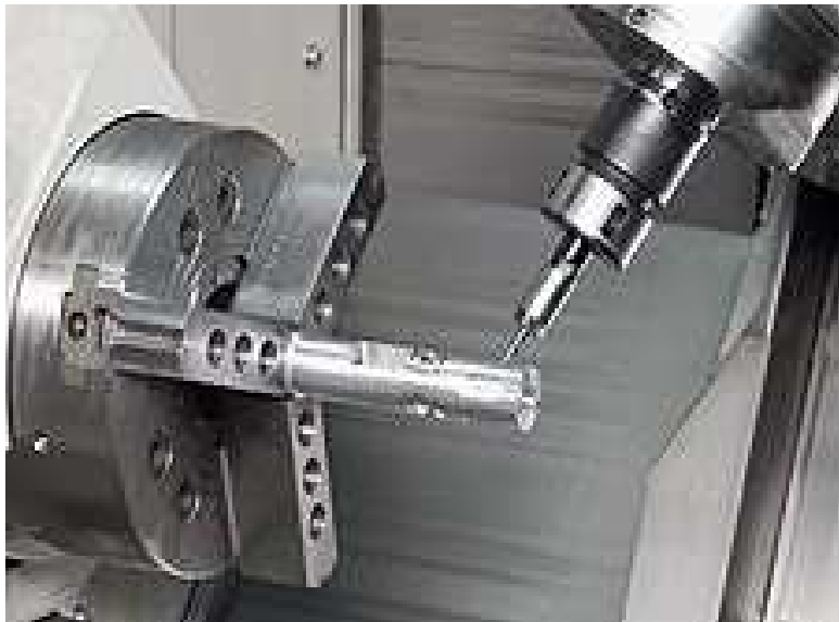
Fig. 5. CNC mill-turn center
