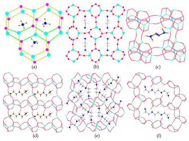
Fig. 13. The structures of six compounds:(a) CoZnPO<sub>4</sub>-I;(b) CoZnPO<sub>4</sub>-II;(c) CoZnPO<sub>4</sub>-III; (d) CoZnPO<sub>4</sub>-IV;(e) CoZnPO<sub>4</sub>-V;(f) CoZnPO<sub>4</sub>-VI.
