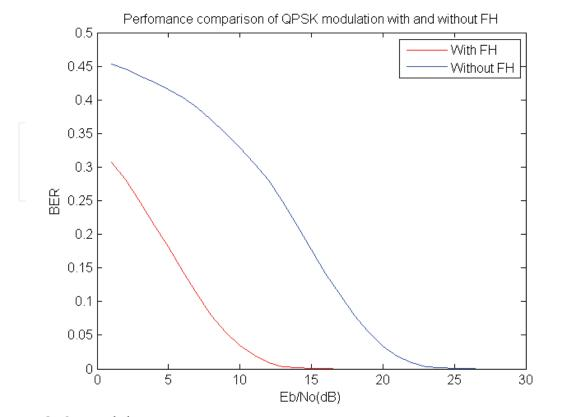
Fig. 11. QPSK modulation
