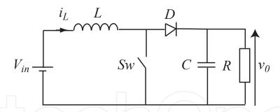
Fig. 2. Bosst converter structure
