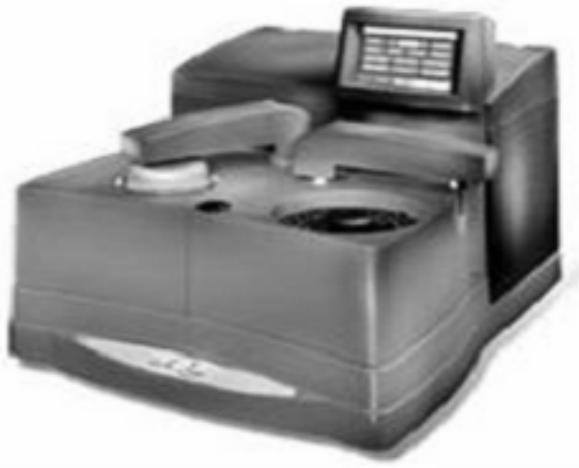
Fig. 7. Q1000 Build 275 DSC instrument
